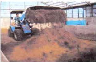
理想的な発酵条件ときめを細かくするため機械により数回攪拌します。
